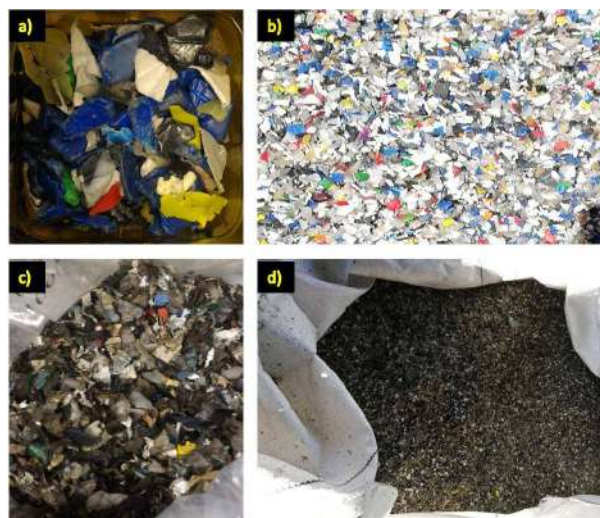
MPS a) in flakes, b) dalla pezzatura < 4 mm. FV c) in flakes, d) dalla pezzatura < 4 mm.
